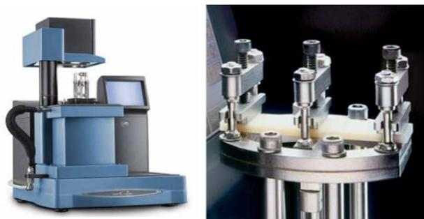
Figura 3.6 - Equipamento de DMA modelo Q800 (esquerda) e suporte *dual cantilever* (direita)
