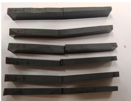
Figura 4.16 - Provetes com 3% GNPs após teste de flexão
