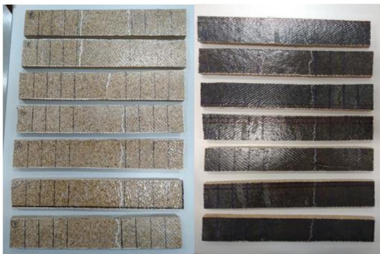
Figura 4.21 - Falhas ocorridas nas configurações C0 e C1
