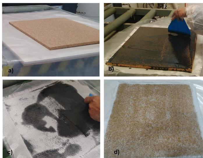
Figura 3.5 - Produção dos compósitos: (a) placa de cortiça cortada com as dimensões pretendidas, (b) aplicação de parte da dispersão EP/GNPs na cortiça, (c) aplicação da restante dispersão no tecido de fibra e (d) compósito preparado com resina sem GNPs
