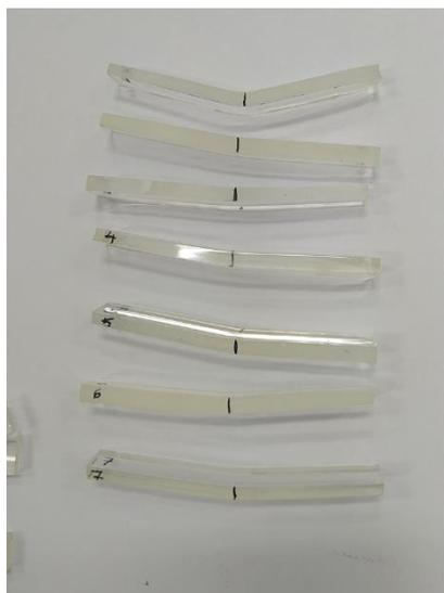
Figura 4.15 - Provetes de EP após teste de flexão
