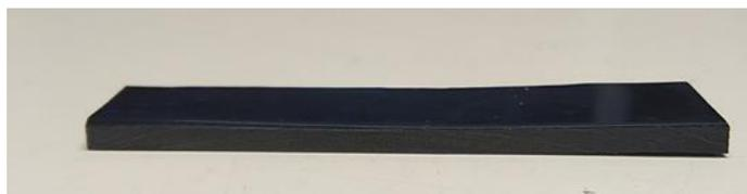
Figura 3.4 - Exemplo de provete de resina EP com grafeno
