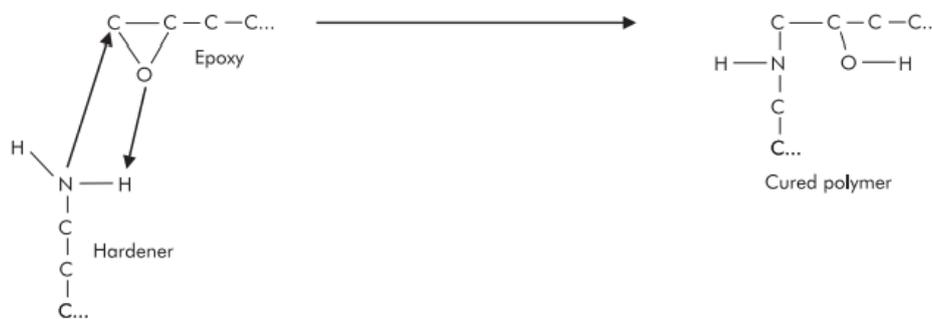
Figura 2.4 - Processo de cura de uma resina epóxi com endurecedor com grupo amina [9]
