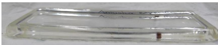
Figura 3.3 - Exemplo de provete de resina EP
